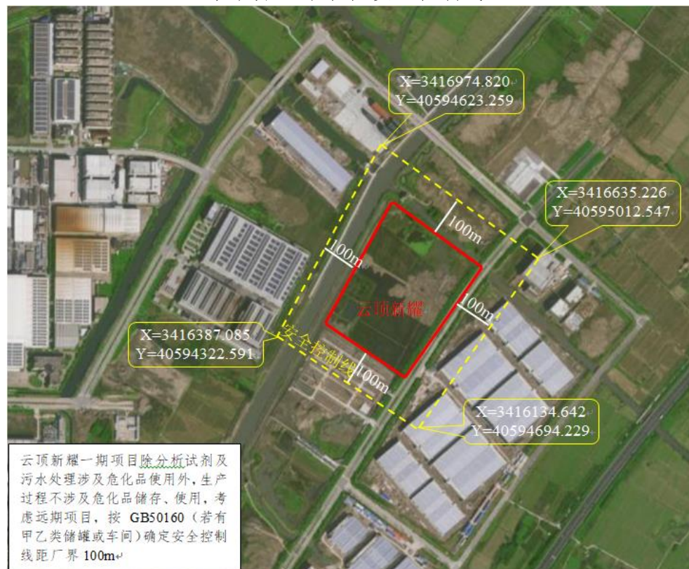
云顶新耀管控点安全控制线
